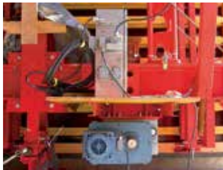
Po potrebi se za premještanje može koristiti električni pogon. Može se montirati i naknadno na kotač s vijencem.
