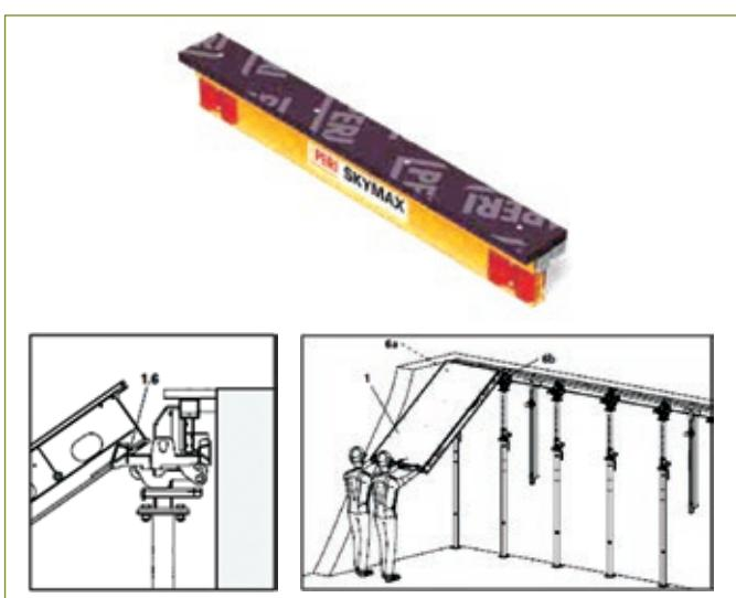
Nosači za izjednačavanje služe za popunjavanje zona prilagodbe / krpanja u slučaju da elementi ne pokrivaju prostoriju od zida do zida. Konstrukcijski su napravljeni tako da ih u slučaju pokrivanja širih zona izjednačavanja možemo kombinirati i spojiti po dva komada međusobno, a montiranje zona ispune također se odvija s donje etaže.
