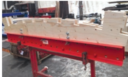
Remenate za geometriju otvora tunela pripremljene su pomoću CNC uređaja na PERI skladištu u Velikom Trgovišću te su zajedno s kompletnim elementima oplata gotove isporučene na gradilište.
