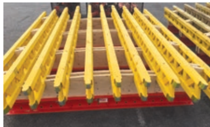
Remenate za geometriju otvora tunela pripremljene su pomoću CNC uređaja na PERI skladištu u Velikom Trgovišću te su zajedno s kompletnim elementima oplata gotove isporučene na gradilište.
