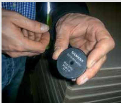
RFID oznaka za ugradnju u podložne ploče: oznake imaju svoj jedinstveni broj koji omogućuje jednoznačno identificiranje ploče.
